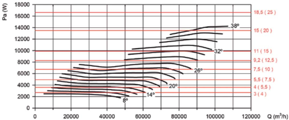
Рекомендованная мощность двигателя кВт (л.с.)
