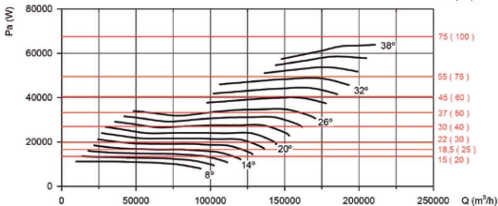
Рекомендованная мощность двигателя кВт (л.с.)
