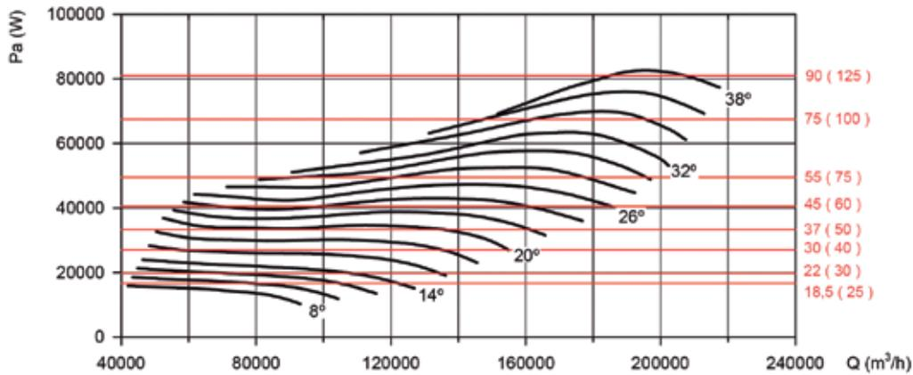
Рекомендованная мощность двигателя кВт (л.с.)
