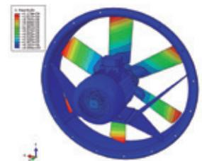
Схема распределения напряжений вентилятора после ударного воздействия. Максимальное напряжение составляет 23,5 МПа для всех осей с расположением в стальной раме.
