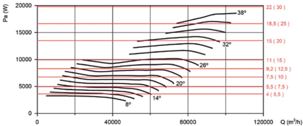
Рекомендованная мощность двигателя кВт (л.с.)
