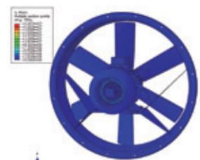
Результат испытания подтверждает, что вентилятор может выдерживать ударное воздействие в соответствии со стандартом, поскольку 23,5 МПа — слишком низкое значение напряжения для стали.
