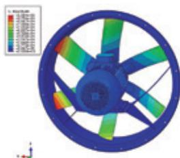
Схема распределения напряжений вентилятора после испытания. Максимальное напряжение составляет 69,7 МПа для стальных частей и 65 МПа для алюминиевых частей. Это максимальное значение для всех осей.
