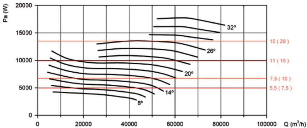
Рекомендованная мощность двигателя кВт (л.с.)
