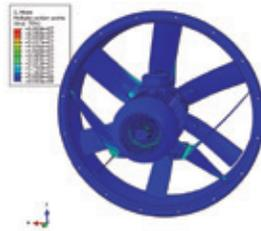
Предел усталости литого алюминия для 28,8 миллиона циклов составляет примерно 80 МПа. Напряжение на всех алюминиевых частях составляет менее 65 МПа, поэтому все они соответствуют требованиям. Предел усталости стали гораздо выше, чем у алюминия. Следовательно, все стальные части также соответствуют требованиям.
