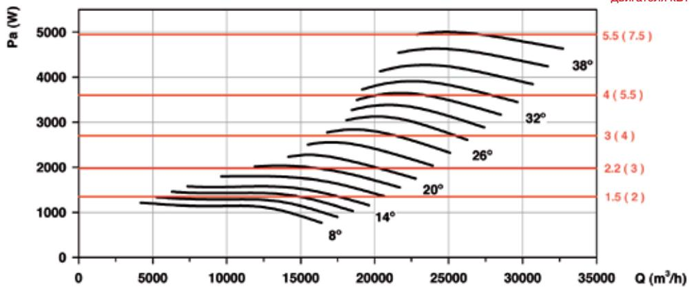
Рекомендованная мощность двигателя кВт (л.с.)
