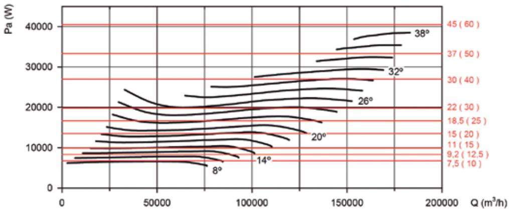
Рекомендованная мощность двигателя кВт (л.с.)
