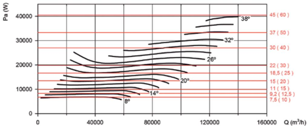
Рекомендованная мощность двигателя кВт (л.с.)
