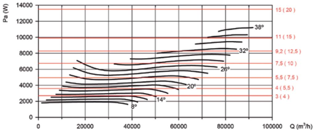
Рекомендованная мощность двигателя кВт (л.с.)
