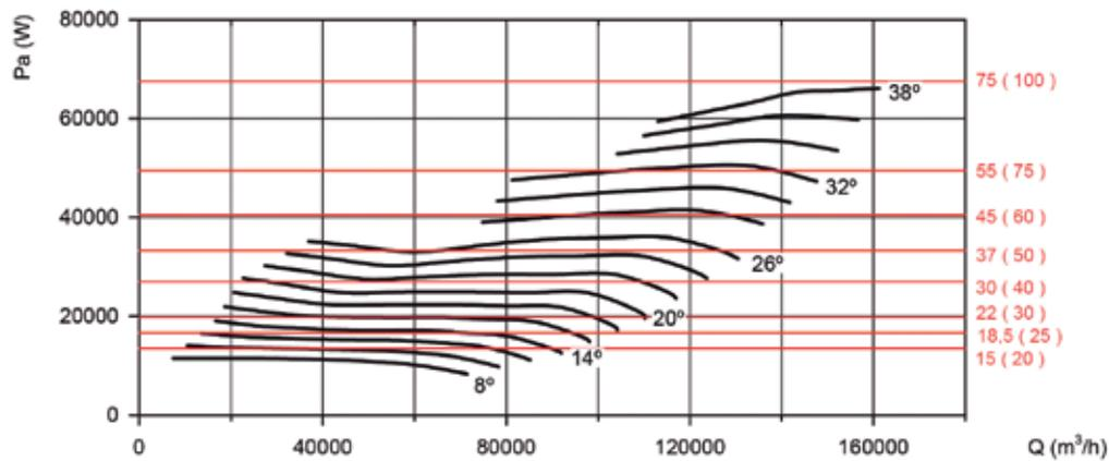
Рекомендованная мощность двигателя кВт (л.с.)
