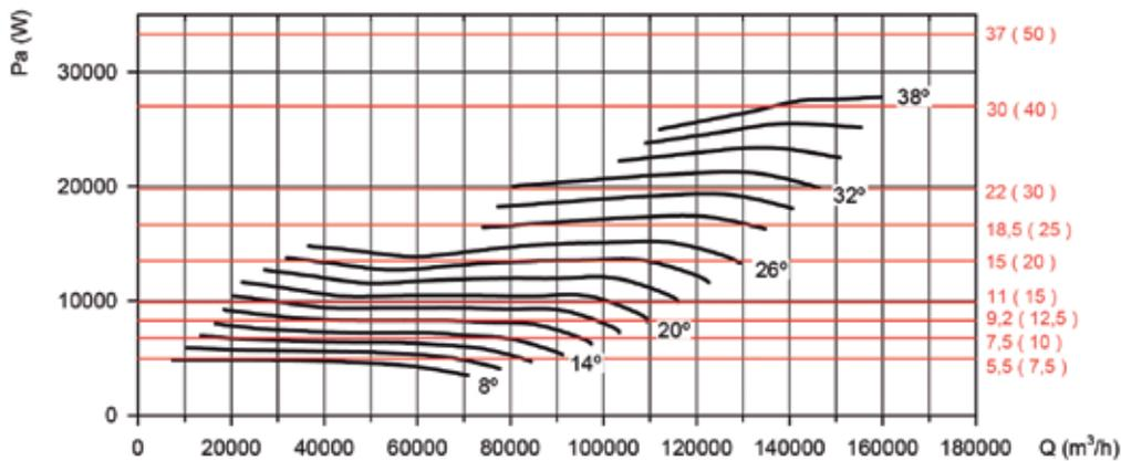
Рекомендованная мощность двигателя кВт (л.с.)
